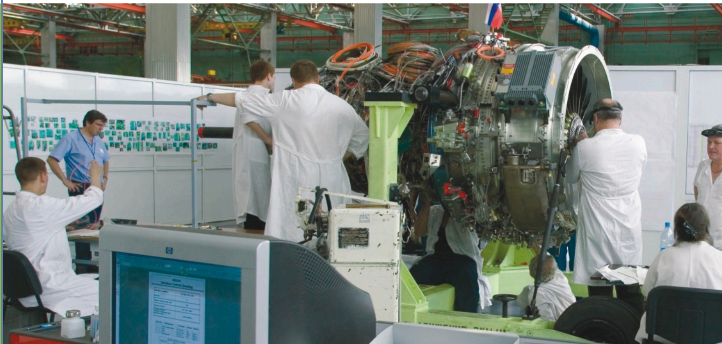
▲ Сборка двигателя SAM 146, НПО «Сатурн» - Snecma (Safran Group). Рыбинск, Ярославская область. SAM 146 engine assembly. NPO Saturn – Snecma (Safran Group). Rybinsk, Yaroslavl region.
